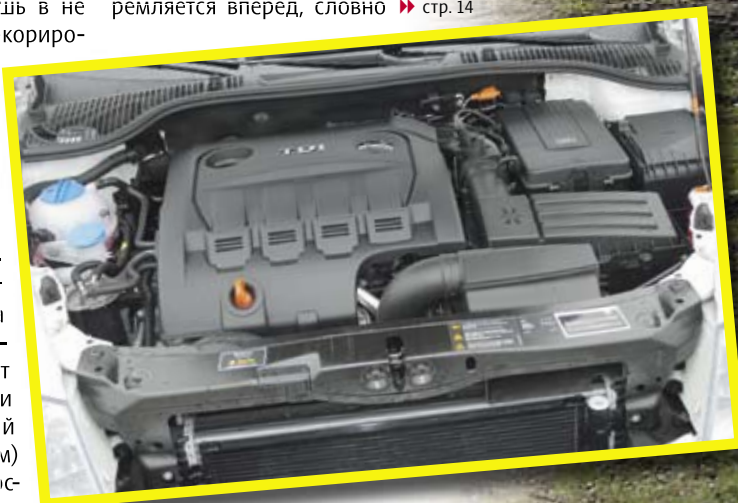
Двухлитровый турбодизель TDI выдает на-гора 170 лошадиных сил.
